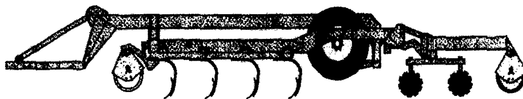
Рисунок 2. Устройство агрегата Centaur
