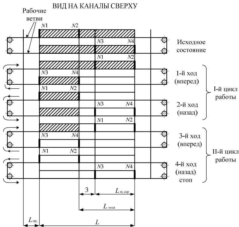
Рис. 24.3. Технологическая схема работы скреперной установки с двумя рабочими каналами
