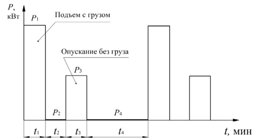
Рис. 20.1. Нагрузочная диаграмма подъемной лебедки
