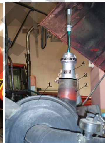
Рис. 4.6. Установка индикатора расхода газов КИМ-13671 на впускную трубу воздухоочистителя: 1 – воздухоочиститель; 2 – впускная труба; 3 – проставка; 4 – индикатор расхода газов КИ-13671
