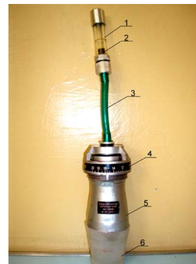
Рис. 4.3. Индикатор расхода газов КИ-13671: 1 – прозрачная трубка; 2 – поршень сигнализатора; 3 – удлинитель; 4 – крышка со шкалой расхода газов, л/мин; 5 – корпус индикатора; 6 – полиэтиленовый наконечник
