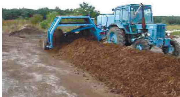
Рисунок 1. Прицепной роторно-лопастной аэратор навозно-компостных смесей в работе
