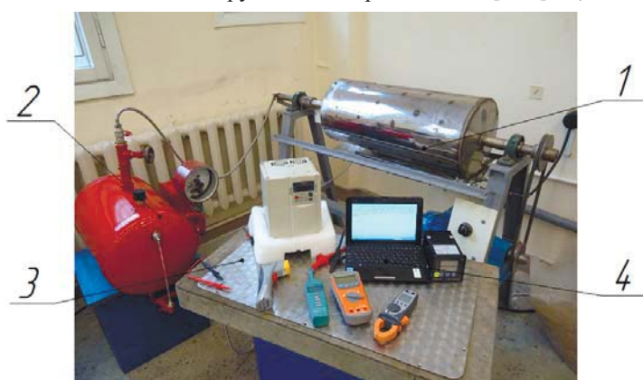
Рисунок 2. Общий вид экспериментального стенда : 1 – обжарочный аппарат; 2 – парогенератор; 3 – контрольно-измерительные приборы; 4 – персональный переносной компьютер ASUS 1005 PX
