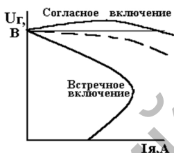
Рис. 6.6. Внешняя характеристика генератора со смешанным возбуждением
