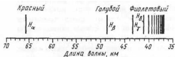
Рис. 1. Линейчатый спектр атома водорода в видимой области
