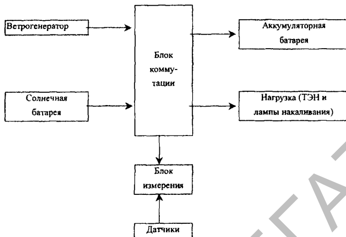
Рисунок 1 – Блок-схема экспериментальной ВГЭУ
