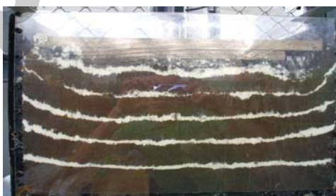
Рисунок 5. Уплотнение почвы штампом с элементом мало изношенной шины ведущего колеса при нагрузке силами 3 (а) и 9 (б) кН соответственно
