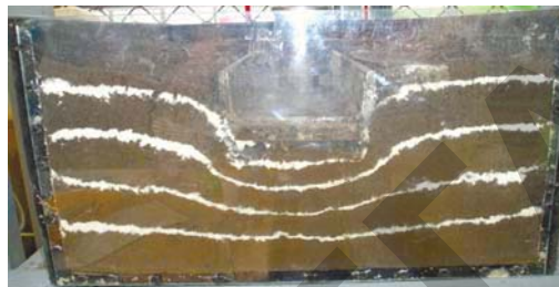
Рисунок 4. Уплотнение почвы штампом с элементом шины переднего колеса при нагрузках силами 3 (а) и 9 (б) кН соответственно
