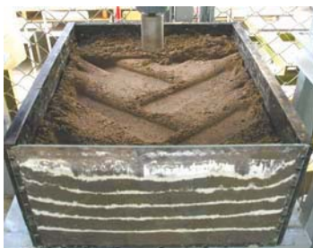
Рисунок 4. Уплотнение почвы штампом с элементом шины переднего колеса при нагрузках силами 3 (а) и 9 (б) кН соответственно
