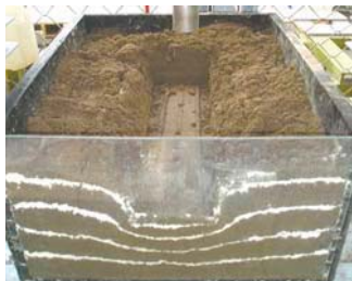
Рисунок 4. Уплотнение почвы штампом с элементом шины переднего колеса при нагрузках силами 3 (а) и 9 (б) кН соответственно
