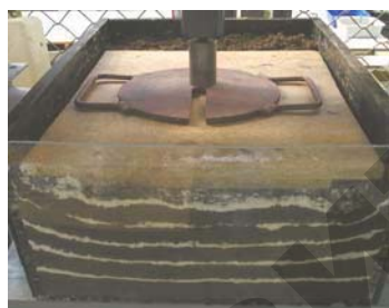
Рисунок 5. Уплотнение почвы штампом с элементом мало изношенной шины ведущего колеса при нагрузке силами 3 (а) и 9 (б) кН соответственно
