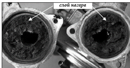
Рисунок 1 – Нагар в системе рециркуляции выхлопных газов (VW Passat)[3]
