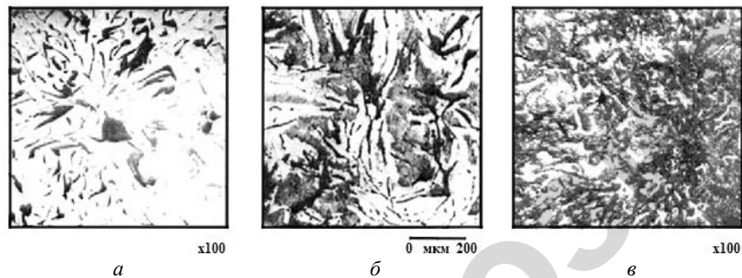
Рис. 1.2. Микроструктура серого чугуна: а — ферритный; б — ферритно-перлитный; в — перлитный
