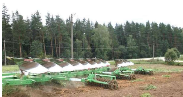
Рис. 1. Плуг ПО-(8+4)-40 с приставками в процессе работы
