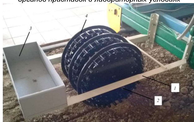
Рис. 3. Общий вид лабораторного образца катковой секции: 1 – рама; 2 – ось; 3 – нагрузочный лоток; 4 – экспериментальный каток
