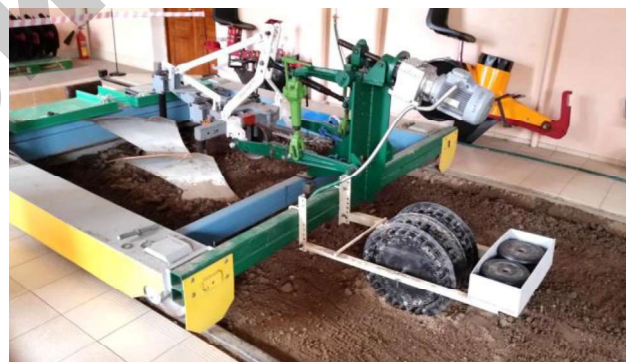
Рис. 2. Установка для исследований работы рабочих органов приставок в лабораторных условиях
