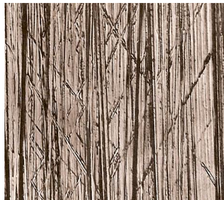
Рисунок 2 – Топография поверхности стали 12X2H4A после финишной обработки ( \times 150 ): а – шлифование; б – хонингование
