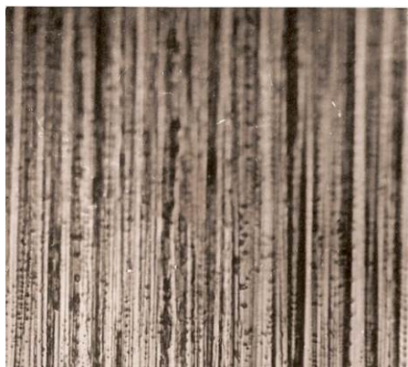
Рисунок 2 – Топография поверхности стали 12X2H4A после финишной обработки ( \times 150 ): а – шлифование; б – хонингование
